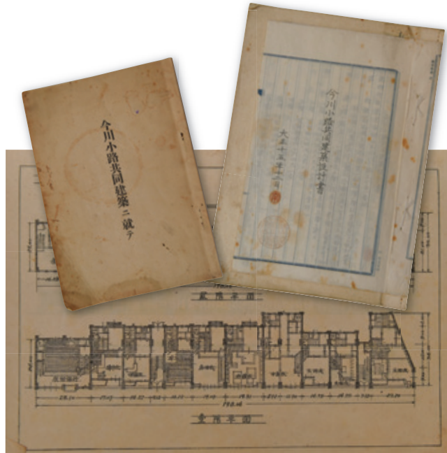
パンフレット「今川小路共同建築二就テ」と「今川小路共同建築設計書」 パンフレットには平面図も示されている。また、設計書には建材等に関する細かい情報が記されている。
